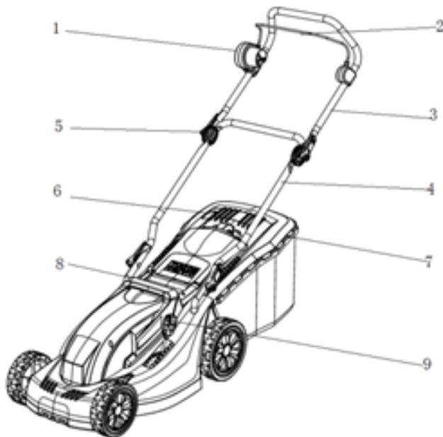
1. Распределительная коробка. 2. Выключатель. 3. Верхняя часть рукоятки. 4. Средняя часть рукоятки. 5. Быстрозажимной фиксатор. 6. Индикатор наполнения травосборника. 7. Травосборник. 8. Нижняя часть рукоятки. 9. Ручка регулировки высоты скашивания.
