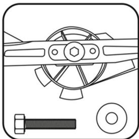
3. Установите тарельчатую шайбу на нож и закрутите болт крепления ножа
