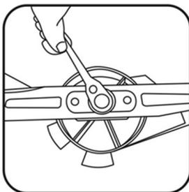
4. Удерживайте нож твердо одной рукой и, используя гаечный ключ, затяните болт крепления ножа против часовой стрелки
