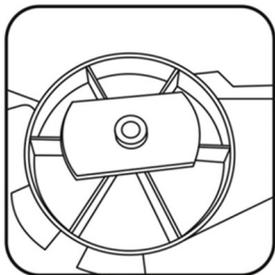
1. Установите адаптер ножа на вал газонокосилки
