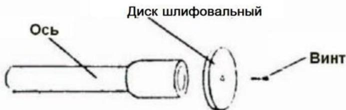
Установка шлифовального цилиндра.
