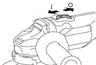
Прежде чем начать работы, всегда дожидайтесь, когда шлифмашина после включения наберет рабочие обороты. Запрещается включать шлифмашину с заблокированным диском.
