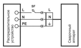
**Примечание:** символ  $\frac{1}{2}$  — обозначение провода заземления. Данный провод имеет желтозеленую маркировку изоляции.
