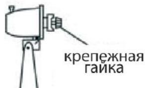
2) Установите заднюю решетку (4) на корпус электродвигателя и закрепите её при помощи гайки (3)
