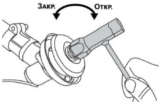
Для крепления катушки с леской снимите чашку с вала, оставив ступицу. Удерживая ключ или отвертку, закрутите катушку с леской против часовой стрелки до упора (левосторонняя резьба).
