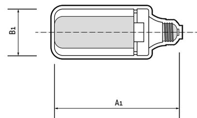
Габаритные размеры лампы PPG T95 в сложенном виде\*
