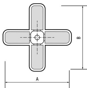
Габаритные размеры лампы PPG T95 в развернутом виде
