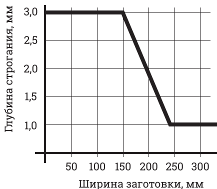
Рис. 4. Соотношение между глубиной строгания и шириной заготовки
