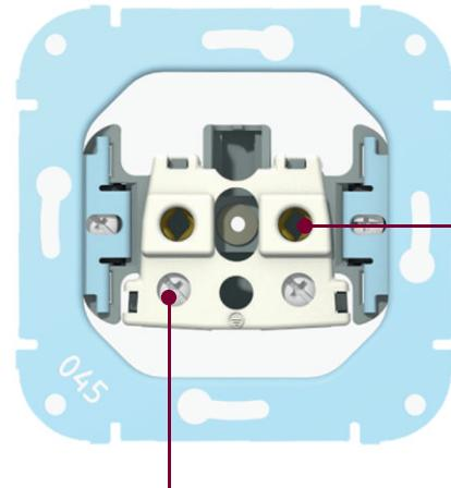
Доступ к винтам контактных зажимов осуществляется при установленном основании в монтажной коробке, это позволяет проводить техническое обслуживание (поджатие винтов при необходимости) без полного демонтажа изделий
