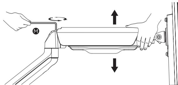
Для балансировки кронштейна с установленным монитором отрегулируйте натяжение пружины с помощью прилагаемого ключа как показано ниже.
