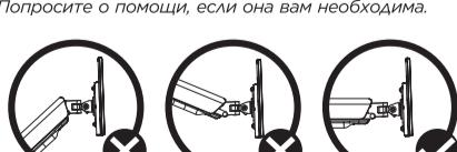
Если кронштейн опускается, поверните регулировочный винт по часовой стрелке, чтобы он оставался в горизонтальном положении.
