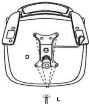
**4. Установите механизм качания (Д) при помощи винтов M6x20мм (Л).**
