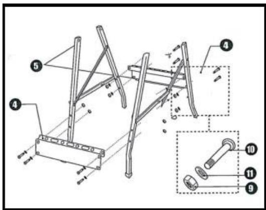
10. Закрепите ножки (5) к механизму подъема (3) при помощи болтов (6), шайб (8) и гаек (7).
