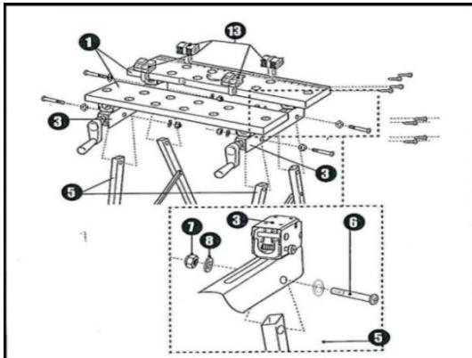
(13) в соответствующие отверстия на рабочей поверхности столешниц (1) в зависимости от габаритов обрабатываемой заготовки.
